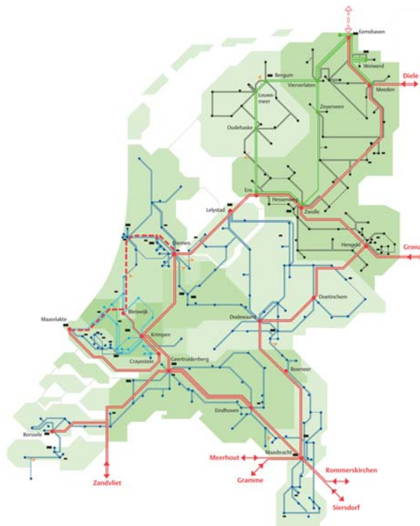
Figuur 1 Overzichtskarta van het Nederlandse hoogspanningsnet (situatie 1 januari 2006). Rode lijnen geven verbindingen op een spanningsniveau van 380 kV aan, groene lijnen 220 kV, blauwe lijnen 150 kV en zwarte lijnen 110 kV. Gestippeld zijn aangegeven netuitbreidingen welke momenteel in aanbouw of voorzien zijn.
