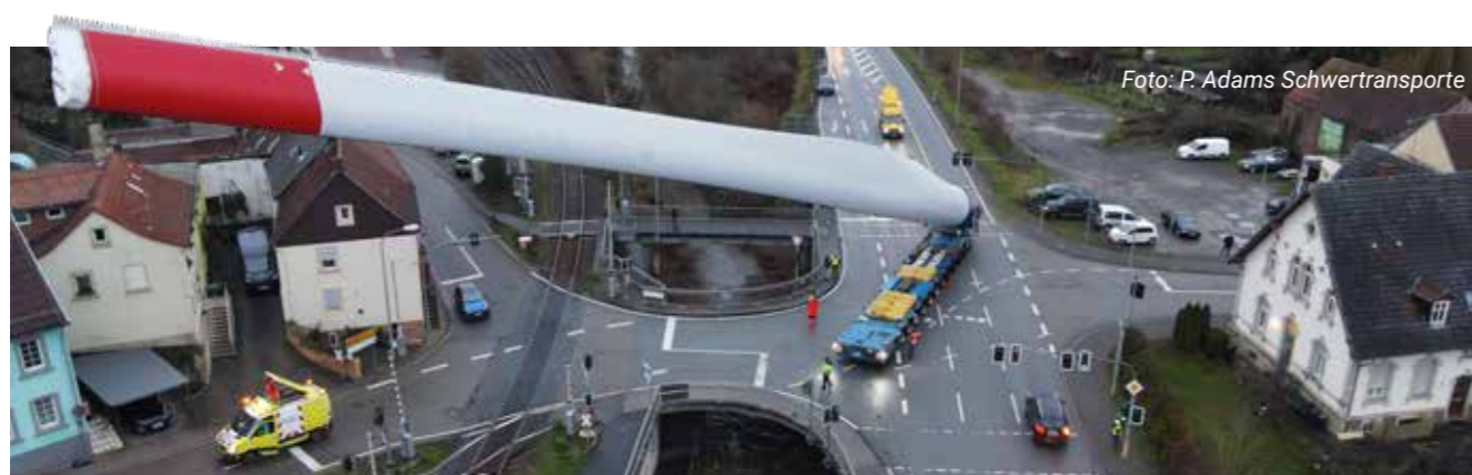
Transport van een 67 meter lang windturbineblad voor een windmolen met een diameter tussen de 130 en 140 meter.
